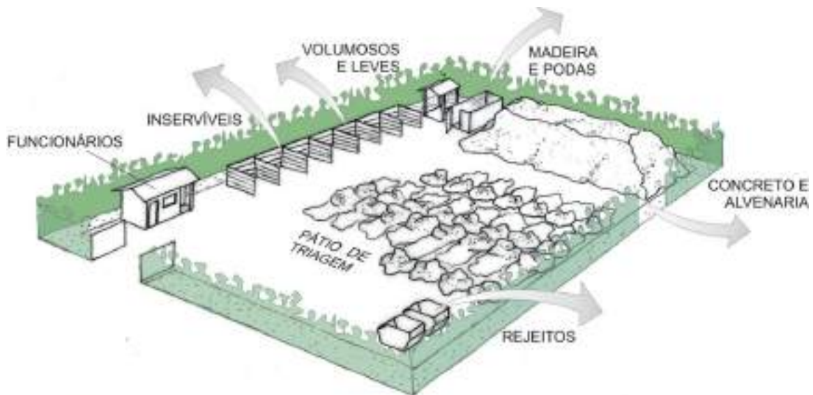
Figura 13 - Desenho ilustrativo da Área de Triagem e Transbordo – ATT – área em torno de 2.000m 2
