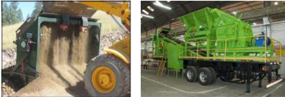
Figura 22 – Equipamentos móveis – peneira vibratória e unidade de reciclagem
