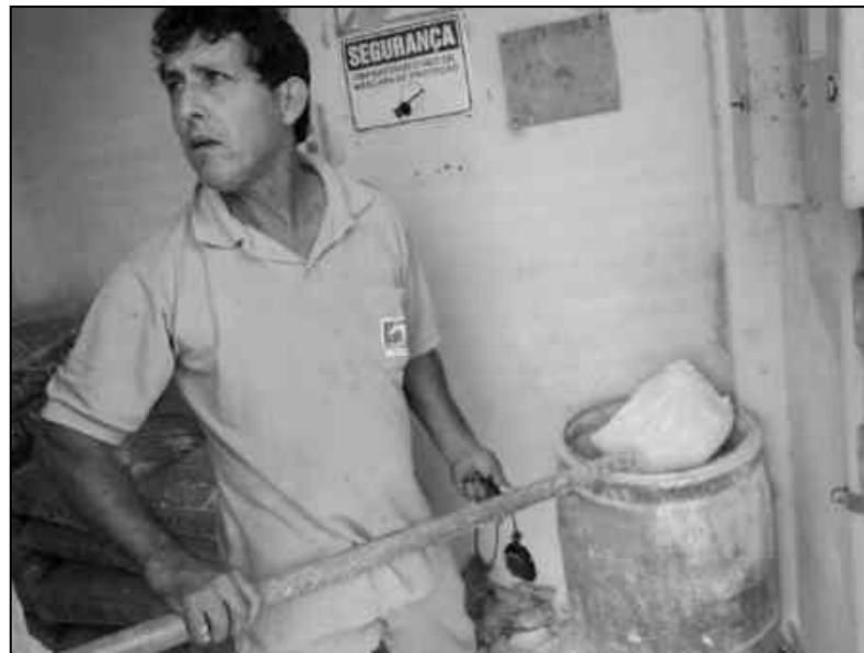
Figura 2.111 - Operador demonstrando a elaboração da solução aquosa de cal.
