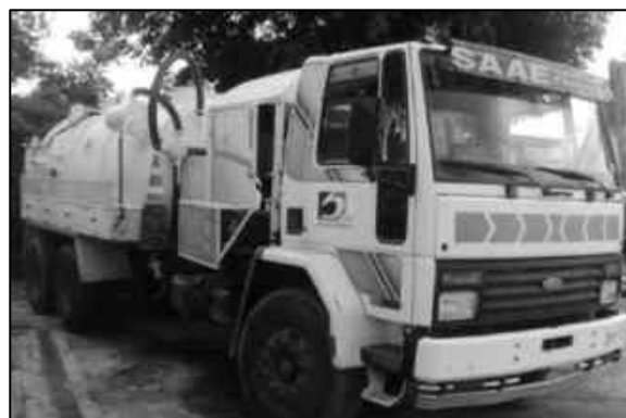
Figura 3.19 - Caminhão hidro jato
