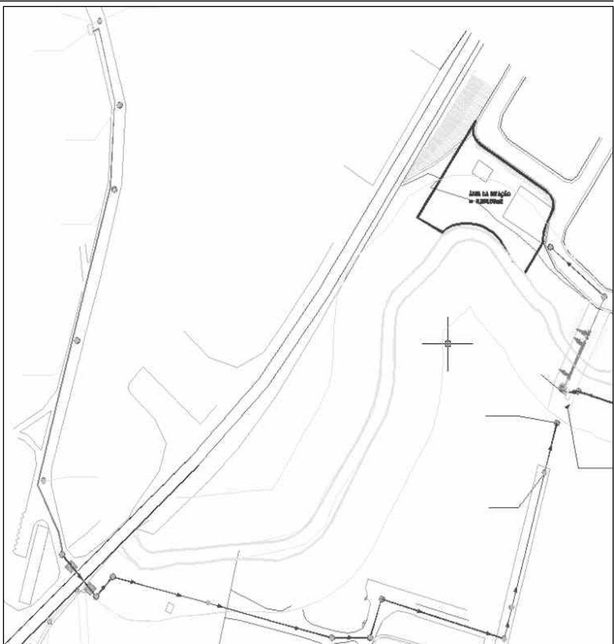
Figura 5.15 - Linha de recalque para Opção 01 – Distrito Arcadas.
