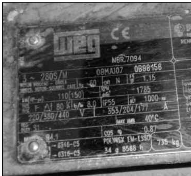
Figura 2.6 – Especificação técnica do conjunto motor bomba em operação da ETA I.
